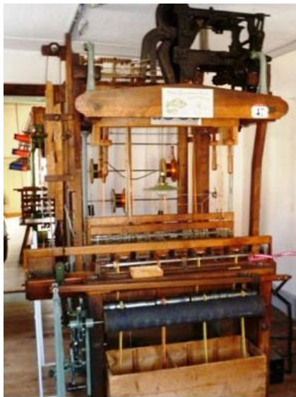
Sägerstuhl von 1881 EG-Webstube, hinterer Raum ex 8 Gänge auf 4 reduziert
