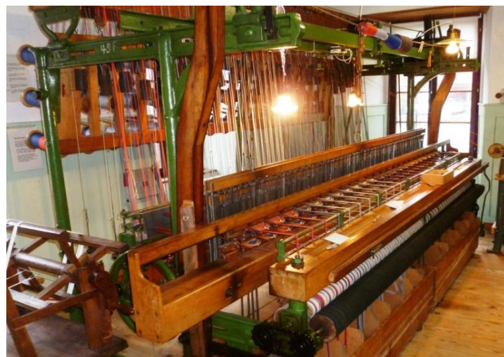
Sägerstuhl EG-Webstube, links 48 Gänge, 49 Faden p.Band
