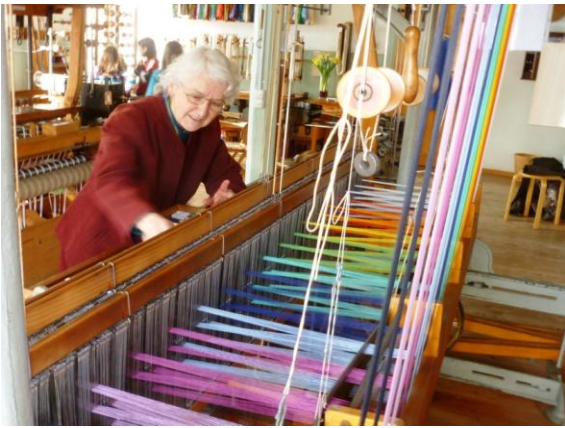
Sägerstuhl EG-Webstube, mitte 36 Gänge, 42 Faden p.Band
